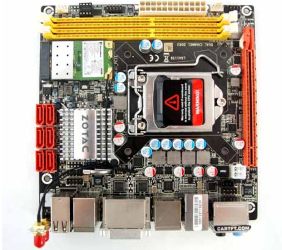
Auch das Innenleben ist gut bestückt somit findet man hier einen PClexpress, einen MiniPClexpress (von Haus aus für das WLAN Modul vorgesehen) und sechs SATA Ports. Des weiteren kann man das System um 4 USB Schnittstellen (via PinHeader) erweitern.
